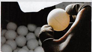
抜き打ち的にボールを取り出し、表面の状態や継ぎ目を確認
