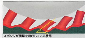
スポンジが衝撃を吸収している状態
