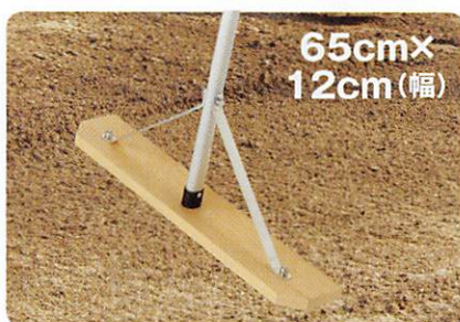
平型、鋭型、上、下を使い分けて整地
