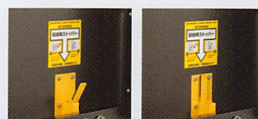
収納時ストッパーロック状態 解除状態 つまみを押しこむことで力をかけずに解除が可能
