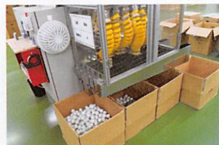
上からボールが落ちてきて、Aに入れば合格。B~Dは3の工程に戻り、Eは規格外で不合格となる
