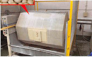
研磨石とともに回転させて研磨する
